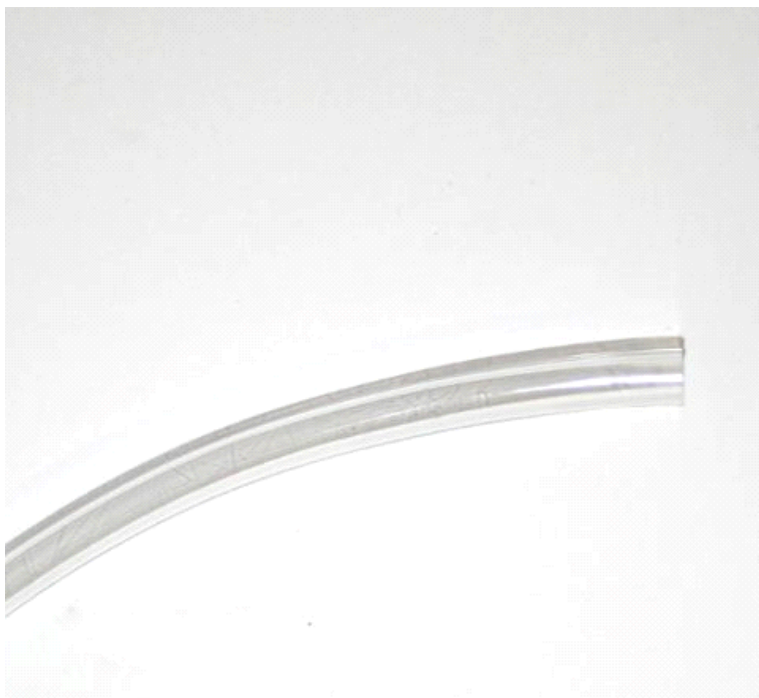
PA-slange \varnothing 3 \times 4 mm, maks 19 bar ved 20°C
